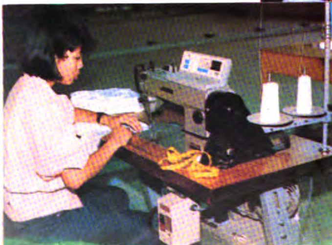
Máy may JUKI (Nhật), sản xuất năm 1989, công suất 12 triệu sản phẩm/năm
