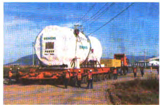
Tiếp nhận vận chuyển máy phát điện 350 tấn của Nhà máy Điện Phú Mỹ
