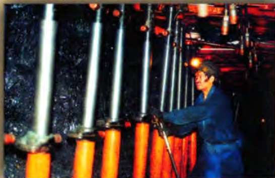
Áp dụng khoa học kỹ thuật tiên tiến vào sản xuất chống lò bằng cột thủy lực di động
